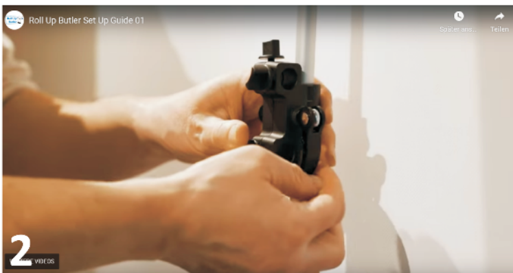
2 Attach Crossholder to RollUp / Befestige Kreuzhalter am RollUp turn 4 plastic screws in / drehe die 4 Plastikschrauben ein
